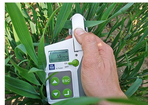
Klorofyllhalten visar gödslningsbehovet men torika kan ge upphov till felvisning. Foto: Yara
