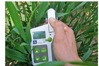
Klorofyllhalten visar gödslingsbehovet men torika kan ge upphov till felavläsning. Foto: Yara
